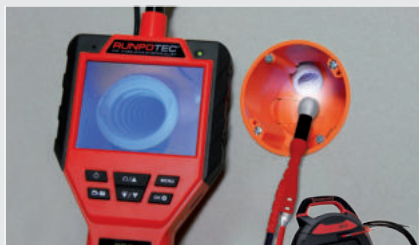
Inspekcija cijevi promjera Ø 14 mm i veće
