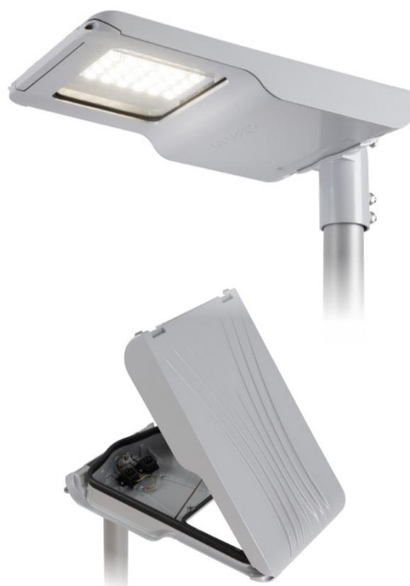
Kućište je izrađeno od lijevanog aluminija i teksture prevučene epoksidnom bojom otpornom na UV zrake. Brtve su od materijala otpornog na ozon i UV zrake koji osiguravaju zaštitu IP66, cijelo učvršćenje ima IK10 certifikat.
